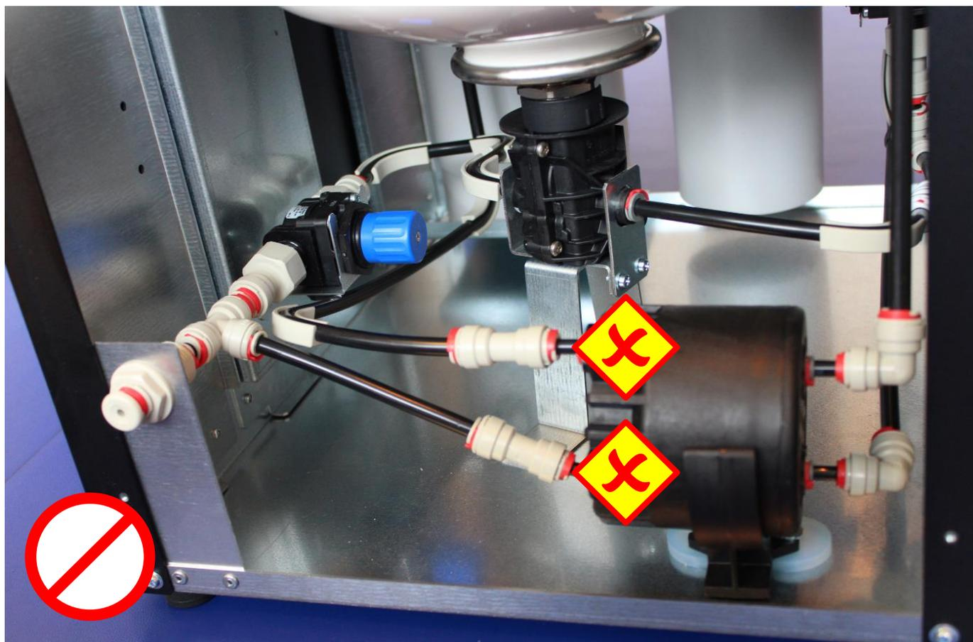
Conecte los adaptadores con las mangueras (4x)
