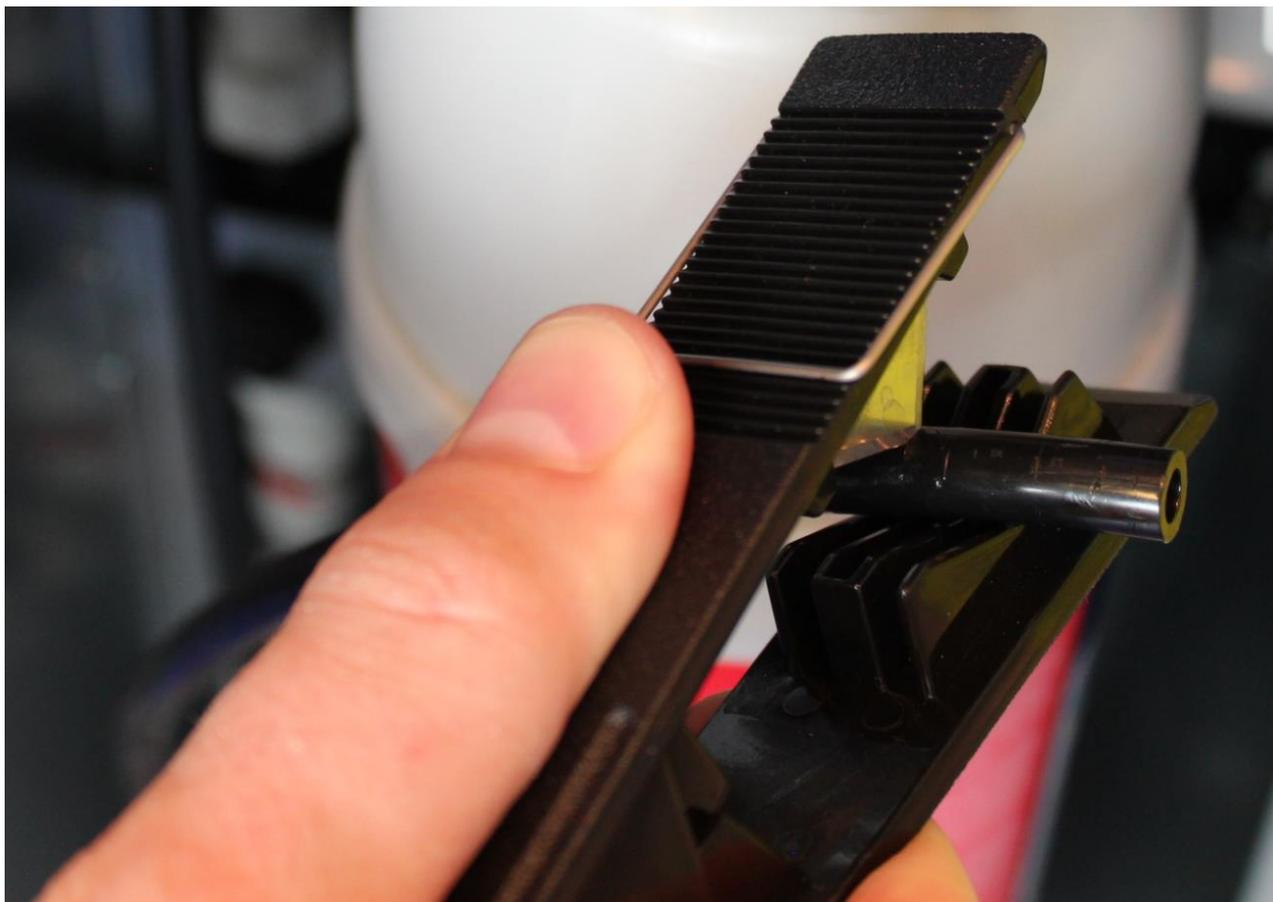
Destornille el adaptador del capilar.
