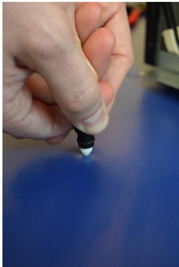
Empuje el capilar a través del adaptador
